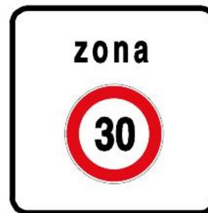
Fig 6: art 135 fig 323/a area a velocità limitata
