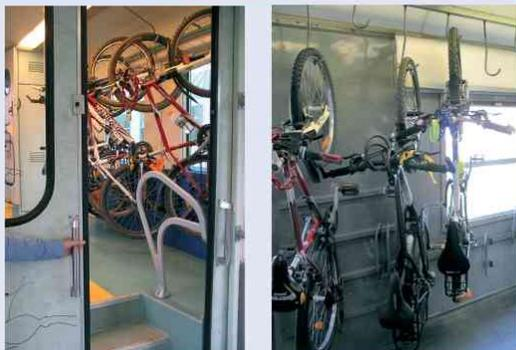
Le bici si appendono al gancio con la ruota anteriore, mentre la ruota posteriore va infilata nella guida di appoggio in basso (a volte sotto una panca reclinabile).
